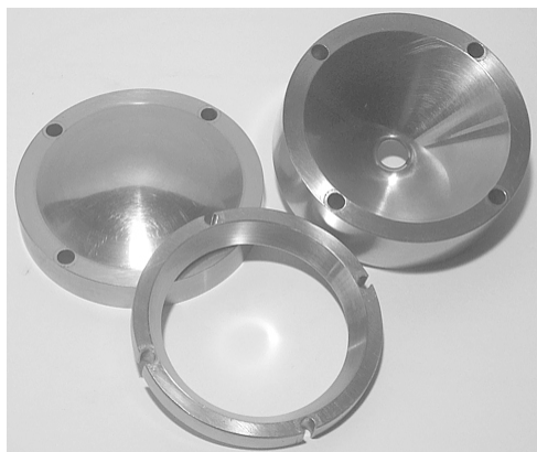
Полеобразующие электроды монополярной ионной ловушки
